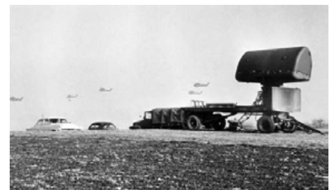
Mobiles Radar: Eine mobile Radaranlage der US-Armee überwacht den Anflug der im Hintergrund zu sehenden Hubschrauber während des großen Wintermanövers „Free Play“.
